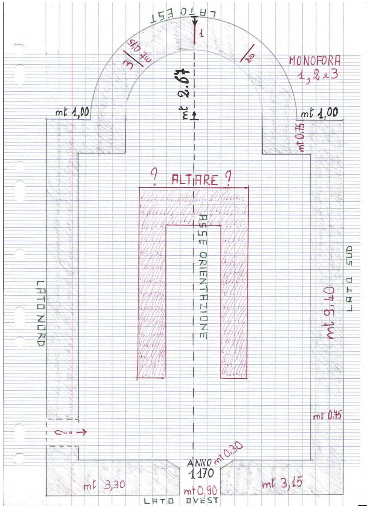
**Pianta A** della Chiesa di Sant'Andrea, disegnata in scala in base all'impianto rimasto al suolo e alle misure reali effettuate. Sono riportate le posizioni probabili delle tre monofore e la dislocazione possibile dell'altare, che poggiava sul pavimento lapideo.
