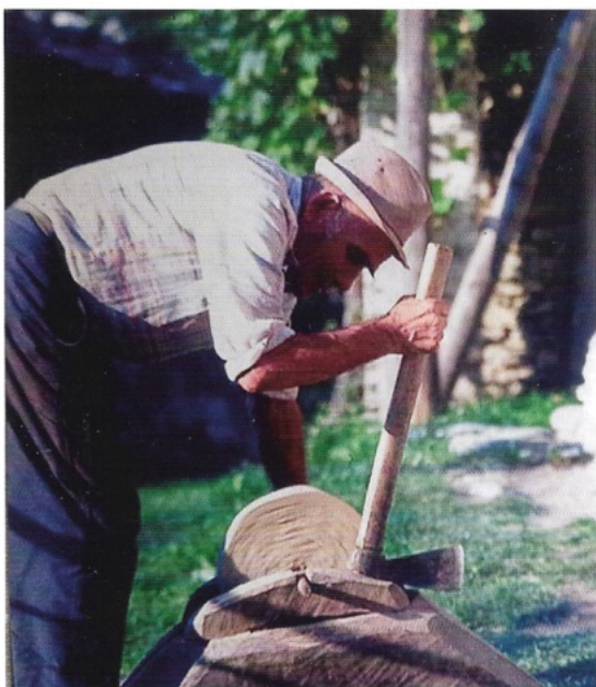
Biagio Daziano affila l'accetta con lo strumento autocostruito pietra mulaira montata su struttura ricavata da un tronco di castagno curvo e tagliato a metà.
